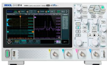
Rigol DHO814 – это совершенно новый 4-х канальный, экономичный и компактный цифровой осциллограф высокого разрешения с полосой пропускания 100 МГц. Изделие имеет максимальную частоту дискретизации 1,25 Гвыб/с, скорость захвата до 1 000 000 осц/с (режим Ultra Acquire), максимальную память хранения до 25 млн.точек, высокое разрешение по вертикали 12 бит и низкий уровень собственного шума.
